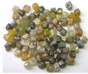
Figura 5. Cristalls cúbics de diamant qualitat industrial
